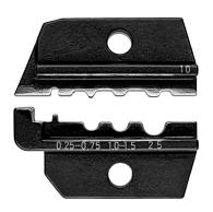
Application: cosses de câbles tubulaires non isolées et bornes à sertir conformes DIN 46237 et connecteurs bout à bout et à sertir non isolés conformes DIN 46341 0,75 / 1,5 / 2,5 mm²
